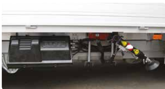
Smart placering av hydraulaggregat - lättåtkomligt för service
